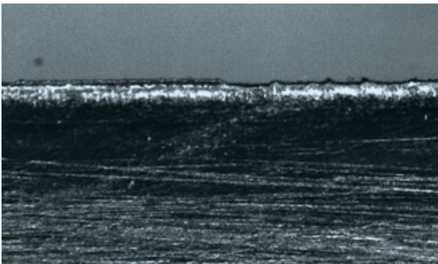
Износ режущей кромки с образованием лунок.
