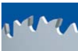
Зубья с чере- дующейся на- клонной задней поверхностью, позитив, с обычной за- дней гранью и ограничителем толщины съема стружки
