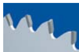
Зубья с чере- дующейся на- клонной задней поверхностью, отрицательный передний угол
