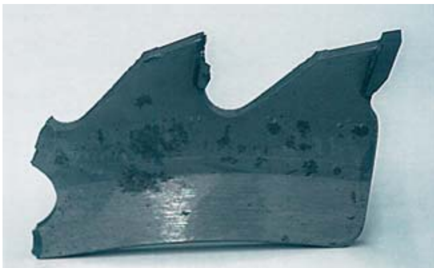
Разрушение режущей кромки вследствие перегрузки инструмента
