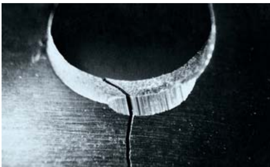
Трещина на корпусе.
