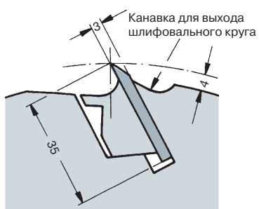
Фреза сборная для обработки плоских поверхностей Hydro RotaPlan Винт зажимной M10x1 Высота ножа 35 мм
